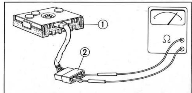
Fig. 5-17 ① Silicon diode rectifier
